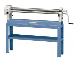
Die Bernardo RM 1000 Manuelle Rundbiegemaschinen sind ideal für das Biegen von Rohren und Zylindern. Die asymmetrische Walzenanordnung ermöglicht ein bequemes Vorbiegen. Zum Konischrunden wird die Hinterwalze schräggestellt.
