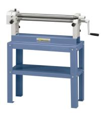
Die Bernardo RM 610 Manuelle Rundbiegemaschinen sind ideal für das Biegen von Metall. Die asymetrische Walzenanordnung ermöglicht ein bequemes Vorbiegen. Zum Konischrunden wird die Hinterwalze schräggestellt.
