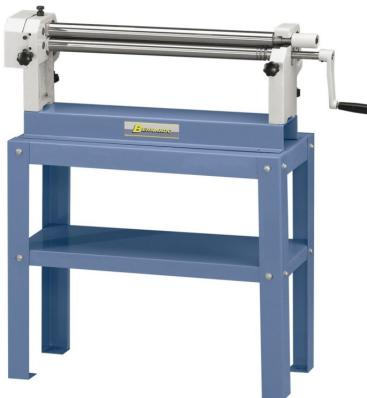
Die Bernardo RM 610 Manuelle Rundbiegemaschinen sind ideal für das Biegen von Metall. Die asymmetrische Walzenanordnung ermöglicht ein bequemes Vorbiegen. Zum Konischrunden wird die Hinterwalze schräggestellt.
