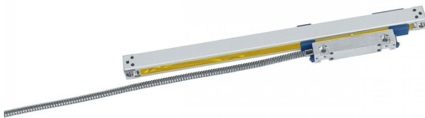
Die linearen Wegmesssysteme der Serie GS sind präzise Messsysteme für lineare Bewegungen. Die mechanische Konstruktion der Abtasteinheit ist mit Miniatatkugellagern mit selbstständiger Führung ausgeführt, welche die Unebenheiten der Maschinenführung infolge von ungenauer Montage bzw. Abnutzung ausgleicht.
