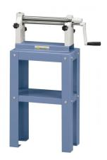
Die Bernardo RM 305 Manuelle Rundbiegemaschinen sind ideal für das Biegen von Metall und anderen Materialien. Die asymmetrische Walzenanordnung ermöglicht ein bequemes Vorbiegen. Zum Konischrunden wird die Hinterwalze schräggestellt.
