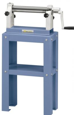
Die Bernardo RM 305 Manuelle Rundbiegemaschinen sind ideal für das Biegen von Metall und anderen Materialien. Die asymmetrische Walzenanordnung ermöglicht ein bequemes Vorbiegen. Zum Konischrunden wird die Hinterwalze schräggestellt.
