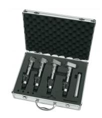
Die Bernardo Digital-3-Punkt-Innen-Feinmessschrauben 3-tlg., 6 - 12 mm / 0,001 mm Innenmessschrauben sind präzise Messgeräte für verschiedene Anwendungen. Die Messschrauben sind ideal für die Messung von Innenmaßen in einem Bereich von 6 bis 12 mm mit einer Genauigkeit von 0,001 mm.
