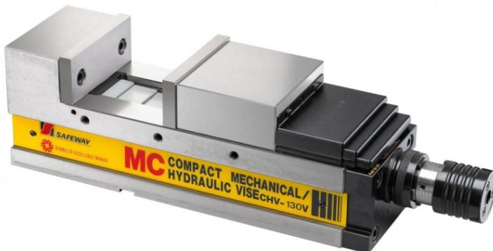
Der Bernardo NC-Maschinenschraubstock CHV 130 V ist geeignet für den Einsatz auf Bearbeitungszentren, im Werkzeug-, Vorrichtungs- und Formenbau. Der stabile Grundkörper aus Sprährhöguss ist gehärtet und geschliffen. Das Spannsystem ist mechanisch/hydraulisch über Handkurbel. Der Schraubstock ist horizontal, seitlich und vertikal einsetzbar.
