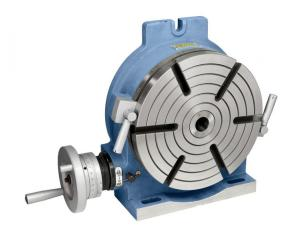
Der Bernardo Horizontal- und Vertikalrundtisch HV 14 Rundtische ist ein vielseitiges Werkzeug für Fräs- und Bohrarbeiten auf Horizontal- oder Vertikalfräsmaschinen, Bohrmaschinen usw. Die Tischplatte ist aus hochwertigem Meehaniteguß hergestellt. Schneckenwelle gehärtet und geschliffen, Schneckenrad aus Spezialguß.
