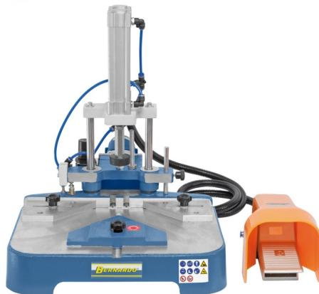
Die Doppel-Keilnutfräsmaschine KNF 2 P eignet sich zur Verbindung von breiteren Rahmenteilen z.B. für Handläufe, Segmentbögen, Rundbogenfenster, Eckbänke usw., da pro Arbeitshub zwei Keilnuten hergestellt werden können. Dieses Modell ist zusätzlich mit einem pneumatischen Niederhalter ausgestattet, welcher über ein Fußpedal betätigt wird.
