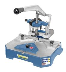
Die manuelle Keilnutfräsmaschine KNF 1 ist ein kompaktes Tischmodell zur Herstellung einer Keilnut pro Arbeitshub. Rahmenverbindungen aller Art, wie z.B. Bilderrahmen, Kranzrahmen, Segmentbögen, Fensterrahmen uvm. sind mit dieser Maschine schnell und kostengünstig herstellbar.
