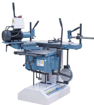
Das Topmodell aus der LBM-Reihe ist mit einem drehbaren Bohr aggregates nach links und rechts bis 60° ausgestattet und ist dadurch die ideale Lösung für den Treppen-, Fenster- und Fassadenbau. Dadurch dass der Motor mittels Einhandbedienung bewegt wird und der Arbeitstisch fix montiert ist, können auch große Werkstücke wie z.B.: Türen leicht bearbeitet werden.
