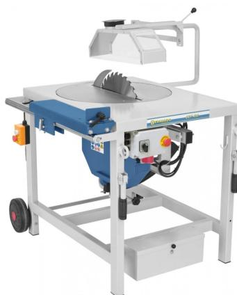
Mit der Universal-Zimmereitischkreissäge UZT 400 können sowohl Kapp- als auch Längsschnitte durchgeführt werden. Durch den Drehteller und das schwenkbare Sägeblatt ergeben sich viele Anwendungsmöglichkeiten wie z.B. Schifter-, Längs-, Gehrungskappschmitt, gerader Kappschmitt. Dadurch ist das Herstellen von Kehl- und Gratsparen sowie das Schneiden von Trauf- bzw. Keilbohlen problemlos möglich.
