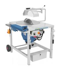
Mit der Universal-Zimmereitischkreissäge UZT 400 können sowohl Kapp- als auch Längsschnitte durchgeführt werden. Durch den Drehteller und das schwenkbare Sägeblatt ergeben sich viele Anwendungsmöglichkeiten wie z.B. Schifter-, Längs-, Gehrungskappschnitt, gerader Kappschnitt. Dadurch ist das Herstellen von Kehl- und Gratsparen sowie das Schneiden von Trauf- bzw. Keilbohlen problemlos möglich.
