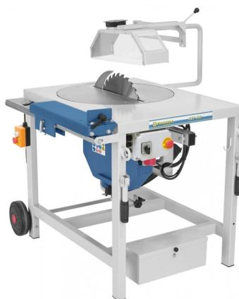
Mit der Universal-Zimmereitischkreissäge UZT 400 können sowohl Kapp- als auch Längsschnitte durchgeführt werden. Durch den Drehteller und das schwenkbare Sägeblatt ergeben sich viele Anwendungsmöglichkeiten wie z.B. Schifter-, Längs-, Gehrungskappschliff, gerader Kappschliff. Dadurch ist das Herstellen von Kehl- und Gratsparen sowie das Schneiden von Trauf- bzw. Keilbohlen problemlos möglich.
