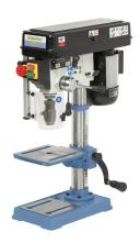
Die preiswerte Tischbohrmaschine TB 14 T mit Keilriemenantrieb ist mit einer Bohrleistung von 14 mm erhältlich. Durch die von Bernardo entwickelte höhenverstellbare Schutzabdeckung werden sowohl der Bohrer als auch das Bohrfutter gänzlich abgedeckt. Dies sorgt für erhöhte Sicherheit und sind daher die ideale Lösung für Bastler und Lehrwerkstätten.
