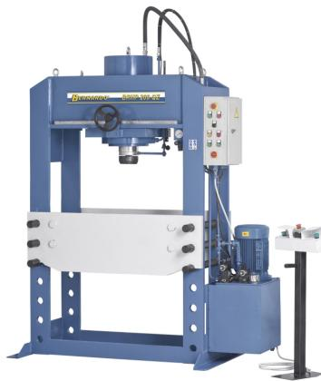
Die Bernardo BRHP 200 QZ Hydraulische Werkstattpresse mit verschiebbarem Zylinder ist ideal geeignet zum Ausrichten von Achsen, Wellen usw., aber auch zum Ein- und Auspressen von Bolzen, Lagern, Buchsen uvm. Sie ist hochwertig und für den industriellen Einsatz konzipiert.
