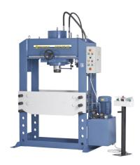
Die Bernardo BRHP 150 QZ Hydraulische Werkstattpresse mit verschiebbarem Zylinder ist ein leistungsstarkes Werkzeug für verschiedene Anwendungen. Die Presse verfügt über eine Druckkraft von 150 to und einen Durchgang zwischen den Ständern von 1000 mm. Der Kolbenhub beträgt 400 mm und der Zylinderdurchmesser 280 mm. Die maximale Druckkraft liegt bei 245 bar und die maximale Arbeitshöhe bei 950 mm.
