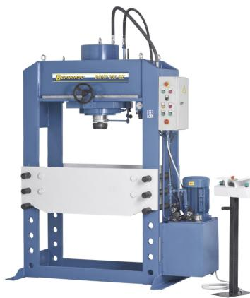
Die Bernardo BRHP 100 QZ Hydraulische Werkstattpresse mit verschiebbarem Zylinder ist ideal geeignet zum Ausrichten von Achsen, Wellen usw., aber auch zum Ein- und Auspressen von Bolzen, Lagern, Buchsen uvm. Sie ist hochwertig und für den industriellen Einsatz konzipiert.
