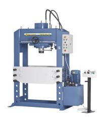
Die Bernardo BRHP 100 QZ Hydraulische Werkstattpresse mit verschiebbarem Zylinder ist ein leistungsstarkes Werkzeug für verschiedene Anwendungen. Die Presse verfügt über eine Druckkraft von 100 to und einen Durchgang zwischen den Ständern von 1000 mm. Der Kolbenhub beträgt 400 mm und der Zylinderdurchmesser 220 mm. Die maximale Druckkraft liegt bei 265 bar und die maximale Arbeitshöhe bei 950 mm.
