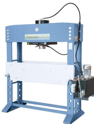
Die Bernardo HWP 160-1500 Hydraulische Werkstatt presse mit verschiebbarem Zylinder ist optimal bei Montage- und Richtarbeiten, aber auch bestens geeignet zum Einrichten von Werkzeugen, bei Belastungstests und für Werkstückprüfungen.
