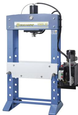
Die Bernardo HWP 30 Hydraulische Werkstattpresse mit verschiebbarem Zylinder ist optimal bei Montage- und Richtarbeiten, aber auch bestens geeignet zum Einrichten von Werkzeugen, bei Belastungstests und für Werkstückprüfungen.
