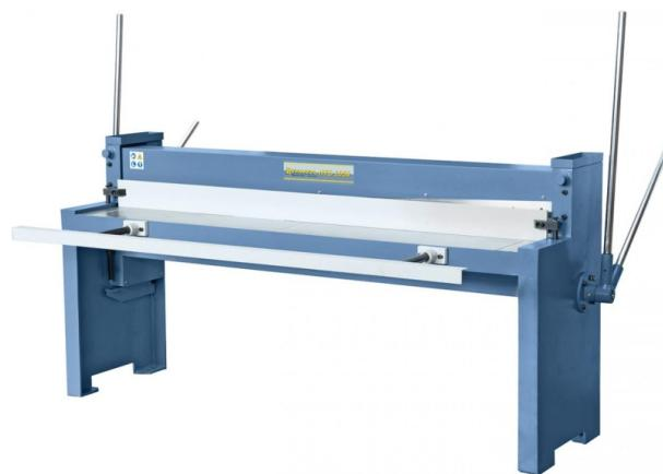
**Bernardo HTS 2050 Handtafelscheren** ist eine moderne Bauform in stabiler Konstruktion. Die Schneidbewegung erfolgt über seitlich angeordnete Hebel. Der Ausziehbare Auflagearm sorgt für sicheres Aufliegen von großformatigen Blechen. Der automatisch wirkende Niederhalter fixiert das Blech.
