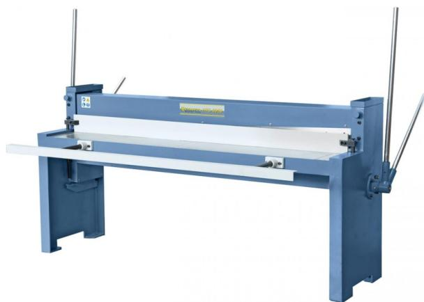
**Bernardo HTS 2050 Handtafelscheren** ist eine moderne Bauform in stabiler Konstruktion. Die Schneidbewegung erfolgt über seitlich angeordnete Hebel. Der Ausziehbare Auflagearm sorgt für sicheres Auflegen von großformatigen Blechen. Der automatisch wirkende Niederhalter fixiert das Blech.
