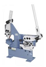
Die Bernardo PBS 22 LS Blech- und Profilstahlscheren sind ideal für den Einsatz in der Metallverarbeitung. Die Scheren sind in der Lage, Stahlbleche mit einer maximalen Dicke von 8,0 mm zu schneiden. Darüber hinaus können Rundmaterial, Vierkantstahl, Flachstahl, L-Stahl und T-Stahl bearbeitet werden.
