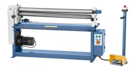
Die Bernardo ESR 1300 x 1,5 Motorische Rundbiegemaschinen ist eine leistungsstarke Maschine für die Bearbeitung von Metall. Die Maschine verfügt über eine Walzenlänge von 1300 mm und kann Bleche mit einer Maximalstärke von 1,5 mm bearbeiten. Die Walzendurchmesser beträgt 75 mm und die Walzengeschwindigkeit kann bis zu 6 m/min erreichen. Die Motorleistung beträgt 0,75 kW.
