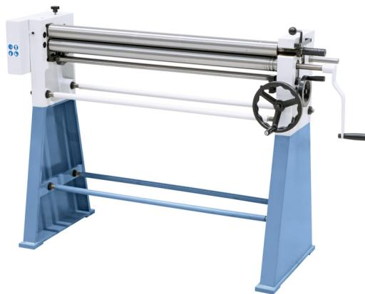
Die Bernardo HRM 1000 Manuelle Rundbiegemaschinen sind ideal für das Herstellen von Kegeln, Rohren, Zylindern und anderen runden Werkstücken. Durch die asymmetrische Walzenanordnung und die obere Walze mit waagrechter Einlegenut können enge Radien hergestellt werden. Die leichte Entnahme des fertigen Werkstücks durch die ausschwenkbare Oberwalze und der Walzenantrieb über ein massives Zahnradgetriebe machen diese Maschinen zu einem optimalen Werkzeug für Ihre Bedürfnisse.
