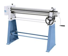
Die Bernardo HRM 1000 Manuelle Rundbiegemaschinen sind ideal für die Verarbeitung von Blechen. Die Maschinen haben eine Walzenlänge von 1035 mm und können Bleche mit einer Maximalstärke von 1,5 mm bei 400 N/mm² bearbeiten.
