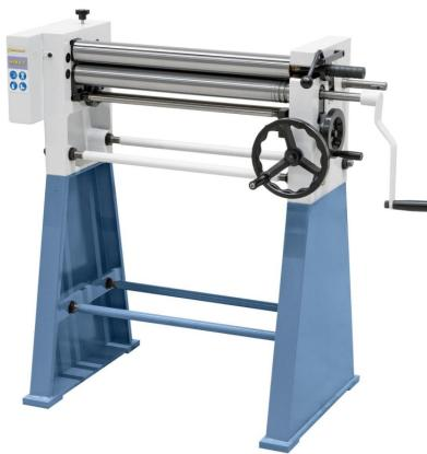
Die Bernardo HRM 610 Manuelle Rundbiegemaschinen sind ideal für das Herstellen von Kegeln, Rohren, Zylindern und anderen runden Formen. Die obere Walze mit waagrechter Einlegenut ermöglicht das Herstellen enger Radien. Durch die asymmetrische Walzenanordnung kann das Vorbiegen bequem durchgeführt werden. Die leichte Entnahme des fertigen Werkstücks wird durch die ausschwenkbare Oberwalze ermöglicht.
