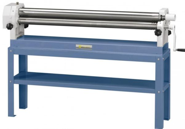
Die Bernardo RM 1300 Manuelle Rundbiegemaschinen sind ideal für das Biegen von Metall. Die asymmetrische Walzenanordnung ermöglicht ein bequemes Vorbiegen. Zum Konischrunden wird die Hinterwalze schräggestellt.
