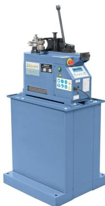
Die Bernardo BM 60 A Elektro-Rohrbiegemaschinen sind für das Kaltbiegen von Rohren aus Stahl, Edelstahl, Aluminium, Kupfer, Messing usw. konzipiert. Sie verfügen über eine NC-Steuerung für die Biegewinkeleinstellung und einen Speicher für bis zu 50 Programme. Die Maschinen sind serienmäßig mit Schnellverstellung der Gegenrollenhalterung bzw. des optionalen Gleitschuhs ausgestattet.
