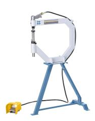
Der Bernardo PGH 500 Pneumatischer Polier- und Glätthammer ist ein vielseitiges Werkzeug für die Bearbeitung von Blechen. Er ist ideal für die Verwendung in der Oldtimerrestauration, Auto- und Karosseriebau sowie anderen Anwendungen, bei denen eine präzise Bearbeitung von Metallflächen erforderlich ist.
