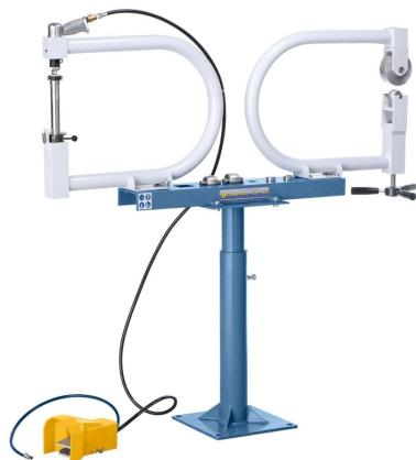
Der Bernardo KGR 500 ist eine Kombination aus Gläthammer und Rollenstreckmaschine. Er ist ideal für die Verarbeitung von Blechen aus Stahl, Aluminium, Messing, Kupfer usw. und findet seinen Einsatz in der Oldtimerrestauration, im Auto- und Karosseriebau sowie bei der Herstellung von Kotflügeln, Türen, Hauben usw.
