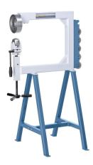
Die Bernardo RSM 560 Rollenstreckmaschinen sind ideal zum Herstellen von konvexen und konkaven Blechteilen wie z.B. Kotflügel, Türen. Hauben usw. Die Maschinen bieten eine einfache Einstellung des Pressdrucks mittels Handrad für den perfekten Radius und eine solide Stahlschweißkonstruktion für präzises Arbeiten. Der Schnellhebemechanismus an der unteren Formrolle ermöglicht die leichte Entnahme des fertigen Werkstücks.
