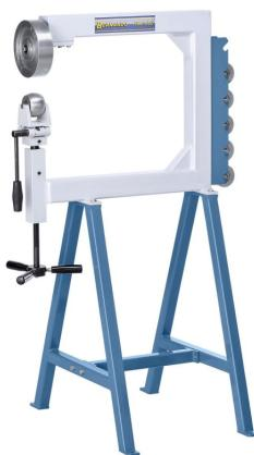
Die Bernardo RSM 560 Rollenstreckmaschinen sind ideal zum Herstellen von konvexen und konkaven Blechteilen wie z.B. Kotflügel, Türen, Hauben usw. Die Maschinen bieten eine einfache Einstellung des Pressdrucks mittels Handrad für den perfekten Radius und eine solide Stahlschweißkonstruktion für präzises Arbeiten. Der Schnellhebemechanismus an der unteren Formrolle ermöglicht die leichte Entnahme des fertigen Werkstücks.
