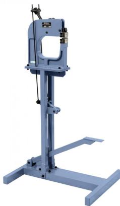
Das Bernardo SS 20 F Stauch- und Streckgerät ist ein robustes Gerät für den professionellen Einsatz. Es eignet sich für Stahlblech bis 1,5 mm bzw. Aluminium bis 1,8 mm (abhängig von der Einlegetiefe). Mit diesem Gerät können Karosserieteile wie z.B. Scheinwerfergehäusen, Radläufen, aber auch Fensterrahmen, Türkanten usw. hergestellt werden.
