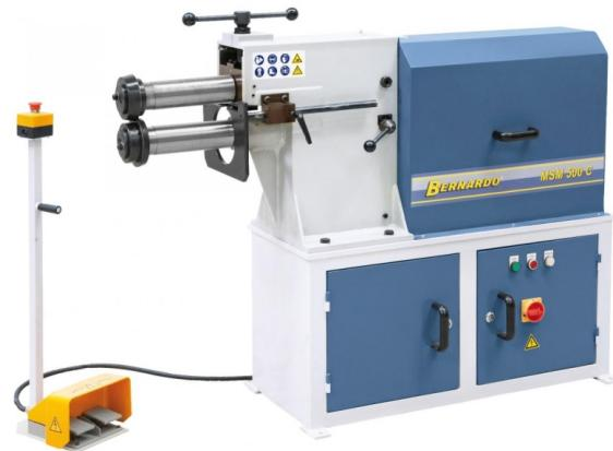
Die Bernardo MSM 500 C Motorische Sickenmaschinen sind leistungsstarke Antriebsmotoren zum Bearbeiten von Blechen mit 4,0 mm Stärke. Sie verfügen über 4 Paar Sicken- und Bördelwalzen im Lieferumfang und einen mobilen Fußschalter für Rechts- und Linkslauf.
