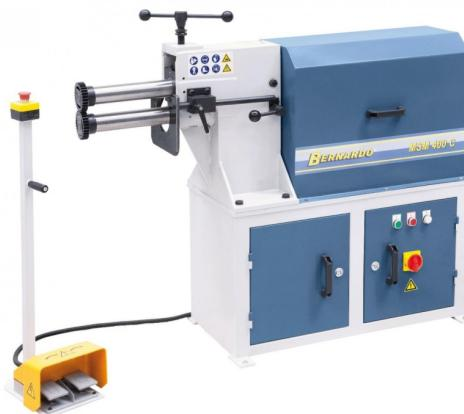
Die Bernardo MSM 400 C ist eine leistungsstarke Sickenmaschine zum Bearbeiten von Blechen mit einer Stärke von bis zu 2,5 mm. Sie ist serienmäßig mit Rechts-Linkslauf ausgestattet, der mittels Fußpedal gesteuert wird. Die Maschine verfügt über eine große Ausladung zum Anbringen von tiefliegenden Sicken und einen einstellbaren Tiefenanschlag für exaktes Arbeiten.
