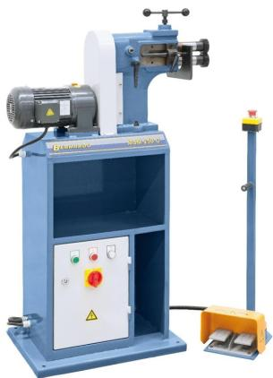
Die Bernardo MSM 250 C Motorische Sickenmaschinen sind robuste und leistungsstarke Geräte zum wirtschaftlichen Herstellen verschiedenster Sickenarten. Sie verfügen über eine hohe Genauigkeit durch präzisionsgelagerte Wellen und übersichtlich angebrachte Schaltelemente. Das Untergestell ist mit einem Ablagefach ausgestattet.
