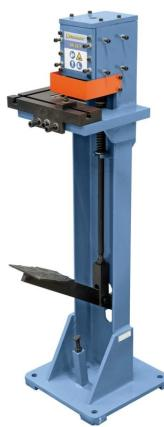
**Bernardo AK 80 F Manuelle Ausklinkmaschinen** sind kompakte Ausklinkmaschinen, serienmäßig mit Untergestell. Die Kraftübertragung auf das Werkstück erfolgt mittels Fußpedal. Zum Ausklinken bis max. 80 x 80 mm, Schnittwinkel 90°. Dauerhafte Präzision durch nachjustierbare Führungen.
