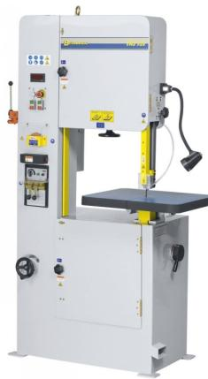
Die Vertikalbandsäge VMS 520 eignet sich zum Sägen von nahezu allen sägbaren Materialien (zB. Stahl, Kunststoff, NE-Metalle, Buntmetalle, ...). Ihren Einsatzbereich findet dieses Modell vorwiegend in der allgemeinen Produktion, im Werkzeug- und Vorrichtungsbau, bei der Herstellung von Stanz- und Schnittwerkzeugen.
