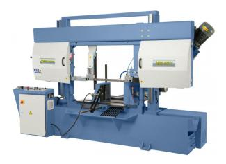
Die vollautomatische Metallbandsäge hat den wesentlichen Vorteil, dass die Zustellung des Sägerahmens über eine präzisionsgeschliffene Linearführung erfolgt. Dadurch ist diese Maschine ideal zum Bearbeiten von Blöcken aus Vollmaterial geeignet. Durch den großen Schnittbereich den diese Serie abdeckt, werden diese Maschinen im Werkzeugbau bis hin zur industriellen Fertigung eingesetzt.
