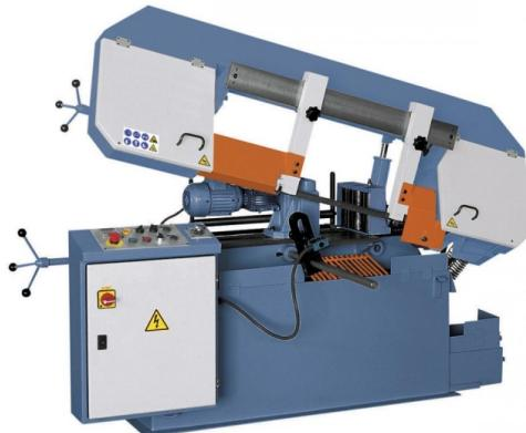
Professionelle Metallbandsägen zum Schneiden von Rohren, Profilen und Vollmaterialien aus Stahl oder Buntmetallen. Durch die umfangreiche Grundausstattung wie z.B.: der Manometer für die Bandspannung, die automatische Bandbruchkontrolle und die Bündelspanneinrichtung haben diese Maschinen ein optimales Preis-Leistungsverhältnis.
