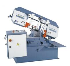
Die Metallbandsäge MSB 320 HG ist mit einem schwenkbaren Sägebügel für Gehrungsschnitte bis 60° ausgestattet. Die stufenlos einstellbare Schnittgeschwindigkeit sowie die automatische Bandbruchkontrolle sorgen für ein komfortables und sicheres Arbeiten.
