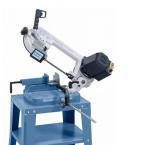
Durch die stufenlos regelbare Schnittgeschwindigkeit und das niedrige Eigengewicht ist diese Maschine optimal für den professionellen Reparatur- und Baustelleneinsatz geeignet.
