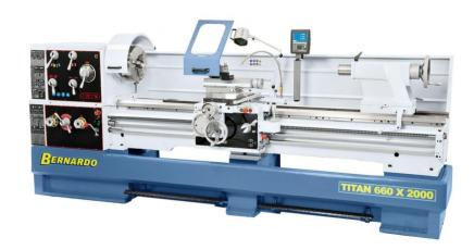
Die Produktionsdrehmaschine Titan 660 x 1500 ist eine moderne, dem heutigen Stand der Technik entsprechende Maschine. Durch die große Bedienerfreundlichkeit (Eilgang, Schnellwechselstahlhalter, mechanische Lamellenkupplung, digitale Positionsanzeige und hoher Leistungsbereich) eignet sich dieses Modell besonders für den Maschinenbau, Anlagenbau, Produktion und Einzelanfertigung.
