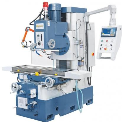
Die konventionelle Bettfräsmaschine BFM 200 überzeugt durch die massive und schwere Graugusskonstruktion, wodurch sie für eine schwere Zerspanung bei großen Werkstücken optimal geeignet ist. Zusätzlich bietet dieses Modell serienmäßig eine pneumatische Werkzeugklemmung, welche ein komfortableres Wechseln der Fräswerkzeuge gewährleistet.
