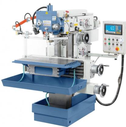
Die konventionelle Universal-Werkzeugfräsmaschine WFM 800 ist für die Bearbeitung von Werkstückgewichten bis 300 kg ausgelegt. Durch die stabile und schwere Graugusskonstruktion und der hohen Steifigkeit der Maschinenbaugruppen erfüllt dieses Modell die besten Voraussetzungen für genaues Arbeiten. Ihren Einsatzbereich findet diese Maschine hauptsächlich im Werkzeug- und Formenbau, sowie im Modell- und Musterbau.
