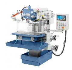
Die konventionelle Universal-Werkzeugfräsmaschine WFM 800 ist für die Bearbeitung von Werkstückgewichten bis 300 kg ausgelegt. Durch die stabile und schwere Graugusskonstruktion und der hohen Steifigkeit der Maschinenbaugruppen erfüllt dieses Modell die besten Voraussetzungen für genaues Arbeiten. Ihren Einsatzbereich findet diese Maschine hauptsächlich im Werkzeug- und Formenbau, sowie im Modell- und Musterbau.
