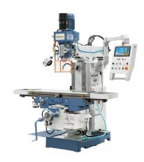
Die Universalfräsmaschine UWF 95 N - eine Weiterentwicklung der bewährten UWF 90 - bietet durch die vergrößerte Tischaufspannfläche einen erweiterten Einsatzbereich sowie hohen Bedienkomfort durch den automatischen Bohrvorschub. Zusätzlich bietet dieses Modell einen Verfahrweg in der x-Achse von 1000 mm sowie eine pneumatische Werkzeugklemmung.
