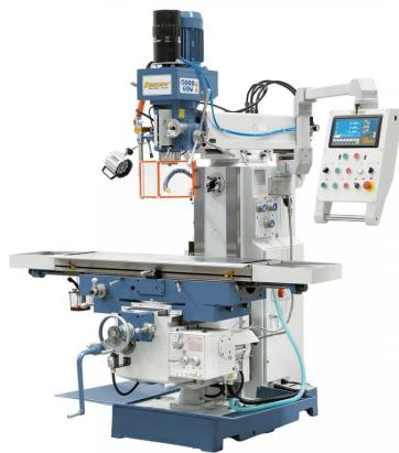
Die Universalfräsmaschine UWF 95 N - eine Weiterentwicklung der bewährten UWF 90 - bietet durch die vergrößerte Tischaufspannfläche einen erweiterten Einsatzbereich sowie hohen Bedienkomfort durch den automatischen Bohrvorschub. Zusätzlich bietet dieses Modell einen Verfahrtsweg in der x-Achse von 1000 mm sowie eine pneumatische Werkzeugklemmung.
