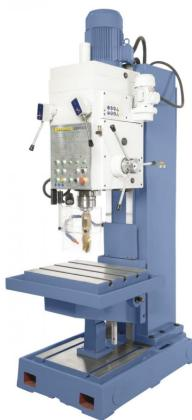
Die Kastenständerbohrmaschine KBM 80 ist für Bohr-, Reib- und Gewindeschneidarbeiten sowohl in der Einzel- als auch in der Serienfertigung geeignet. Durch die massive Graugusskonstruktion kann dieses Modell für schwere Zerspannungsarbeiten in Maschinenbau, Produktion und Anlagenbau eingesetzt werden.
