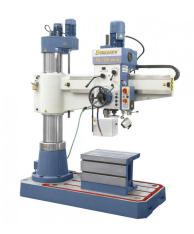
Die kompakte Radialbohrmaschine RD 1300 Vario ist für Bohr-, Senk- und Reibarbeiten von großen Werkstücken ideal geeignet. Durch die vielseitigen Anwendungsmöglichkeiten ist diese Maschine optimal für mechanische Werkstätten, Reparaturbetriebe, Maschinenbau.
