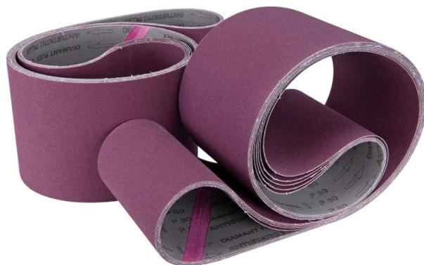
Das Bernardo Gewebeschleifband 2000 x 50 mm - K 120 ist ein universell einsetzbares Schleifband aus Elektrokorund zum Schleifen und Entgraten von Stahlblech, Aluminium, Gussteilen, NE-Materialien, Sperrholz, Weich- und Harthölzern. Es bietet hohe Wirtschaftlichkeit auf Grund hoher Standzeit und Leistung.
