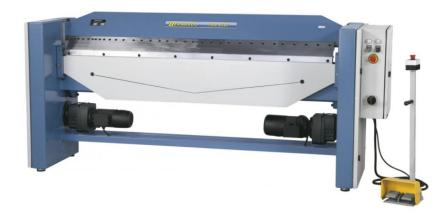
Die Bernardo TBM 2020 Motorische Schwenkbiegemaschinen sind für präzise Arbeiten konzipiert. Die Maschinen verfügen über eine Arbeitslänge von 2020 mm und können Bleche mit einer Maximalstärke von 1,5 mm bearbeiten.
