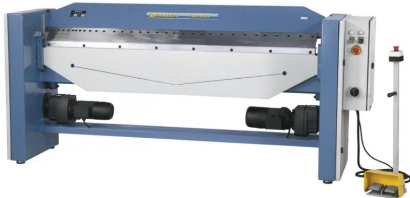
Die Bernardo TBM 2020 Motorische Schwenkbiegemaschinen sind universell einsetzbare Biegemaschinen für den professionellen Einsatz. Bedienung mittels Fußpedal, Hände bleiben frei zum optimalen Positionieren des Bleches. Die Maschinen verfügen über eine segmentierte Oberwange für eine große Anzahl von Biegemöglichkeiten und einen motorisierten Biegevorgang.
