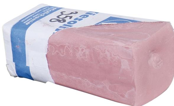
Die Polierpaste "KIESOLIN" eignet sich für sämtliche Metalle und Kunststoffe. Nachpolieren ist häufig nicht mehr erforderlich. Breiter Anwendungsbereich von milder bis besonders abrasiver Wirkung. Für diese Artikelgruppe wird vorrangig Tonerde (Aluminiumoxid) eingesetzt. Sie wird aus Bauxit nach dem Bayer-Verfahren gewonnen, wobei der Härtegrade von der Temperatur des nachfolgenden Glühprozesses abhängt.
