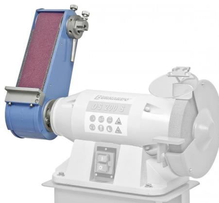
Der Bernardo Schleifaufsatz SA 1 ist ein Schleifaufsatzt mit einer Schleifbandabmessung von 762 x 75 mm und einer Schleifauflage von 180 x 75 mm. Die Schleifband-Geschwindigkeit beträgt 16,4 m/sek. Der Absaugstutzendurchmesser beträgt 38 mm und der Schwenkbereich des Schleifaufsatzes 90°. Das Gewicht des Schleifaufsatzes beträgt 7 kg.
