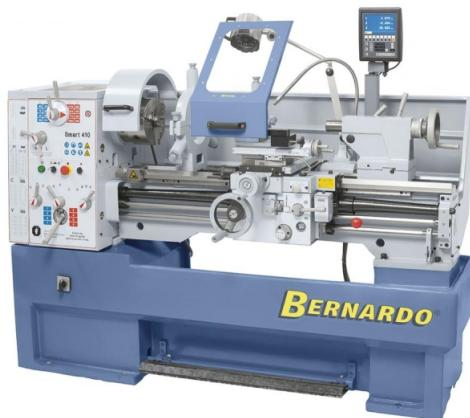
Die Universaldrehmaschine Smart 410 eignet sich zur Ausführung von leichten und mittelschweren Dreharbeiten. Schon die Grundausstattung behinhaltet alle wichtigen Zubehöre, wodurch diese Maschine universell einsetzbar ist. Zur Reduzierung der Fertigungszeiten ist dieses Modell serienmäßig mit einer 3-Achs-Digitalanzeige ausgestattet.
