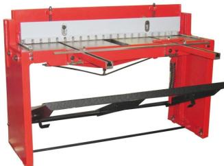
Die Holzmann TBS1320 Tafelblechscheren ist eine professionelle Schere für die Bearbeitung von Blechen. Sie verfügt über eine Materialanschlag mit Feinjustierung bis 700mm und Maßskala, einen vorderen Anschlag bis 880mm einstellbar und einen rechtwinkeligen Materialanschlag auf beiden Seiten des Aufnahmetisches. Die Schere ist auch mit einem automat. wirkender Niederhalter zum Fixieren des Bleches ausgestattet und bietet einen einfachen und bedienerfreundlichen Betrieb durch Fußbedienung.
