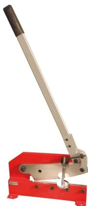
Die Holzmann HS300 Hebelschere ist ideal zum Zuschneiden von Metallplatten, Blechen, Rund- und Flachstählen. Sie verfügt über hochwertige Schneidelemente aus gehärtetem Stahl, die eine lange Lebensdauer gewährleisten. Die Schere bietet eine komfortable Einhandbedienung und einen großen Kapazitätsbereich. Ein Niederhalter verhindert das Verwinden des Blechs beim Schnitt. Der solide Gusskörper und die Laschen zur Befestigung der Maschine sorgen für eine stabile Arbeitsgrundlage.
